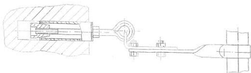
*Схема крепления лесов к стене*
