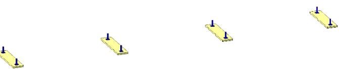
Опорные поверхности рам лесов должны находиться строго в одной горизонтальной плоскости.
