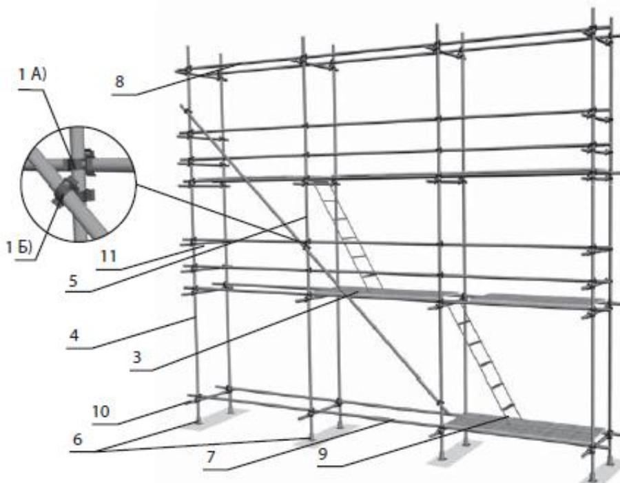
Вариант лесов для каменной кладки собирается из элементов лесов для отделочных работ. Главное различие заключается в том, что настил собирается только на трех ярусах из щитов для каменной кладки. Шаг вертикальных стоек вдоль фасада 1,5 м. Крепление лесов для каменной кладки к стене осуществляется при помощи анкеров, закладываемыми в стену в процессе кладки.
